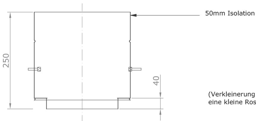
(Verkleinerung des Querschnitts, um eine kleine Rosette setzen zu können)
